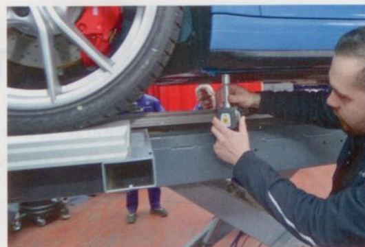
Richard Büttner (Car-O-Liner) erklärt, wie sich die Mess-Spitzen aufsetzen lassen.
