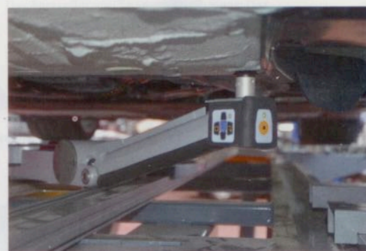
Schritt für Schritt werden alle Messpunkte unter dem Fahrzeug abgefahren.
