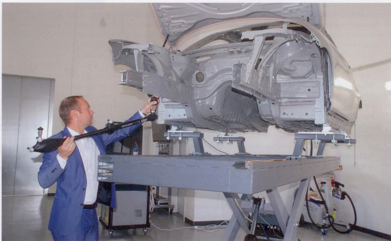
Stephan Paschke, Vertriebsleiter von Car-O-Liner, demonstriert der KRAFTHAND-Redaktion das mobile PointX-System, mit dem sich Karosserien schnell und einfach vermessen lassen. Bild: Schmidt
