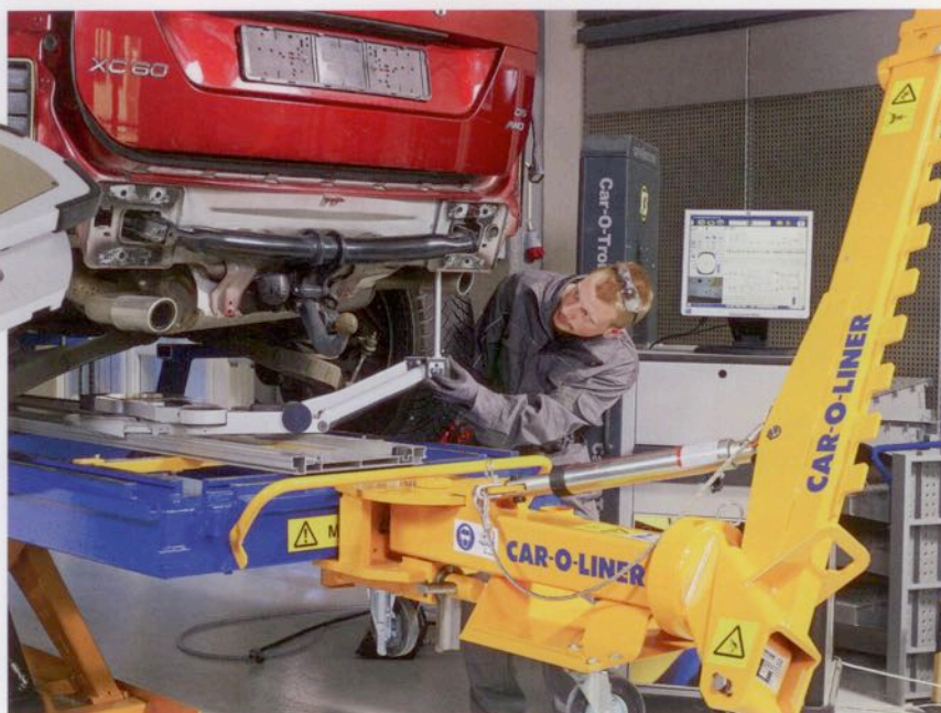
Das schienengeführte elektronische Messsystem Car-O-Tronic Vision2 im Einsatz. Wo die Messpunkte des jeweiligen Fahrzeugs liegen und ob diese in der Toleranz sind, bekommt der Anwender über den Bildschirm durch die Diagnosesoftware Vision2 X3 angezeigt. Bilder: Car-O-Liner
