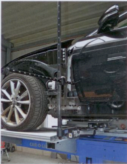
Mit dem Messsystem Car-O-Tronic Vision X3 lässt sich auch die Fahrzeugseite vermessen.
