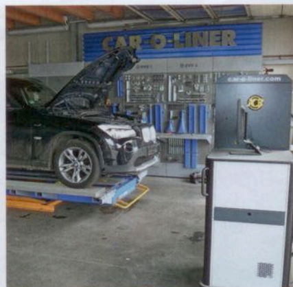
Der K+L-Betrieb Gronemeyer arbeitet mit zwei Mess- und Richtenanlagen von Car-O-Liner.
