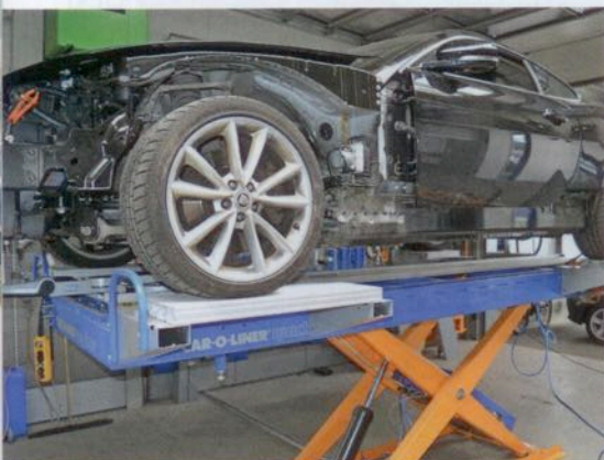
Auf der Richtbank Quick 42 kann man Fahrzeuge vermessen und richten.
