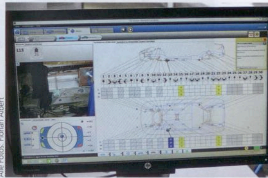
Mit dem Messsystem Car-O-Tronic Vision X3 lässt sich ein Fahrzeug an über 80 Punkten vermessen.
