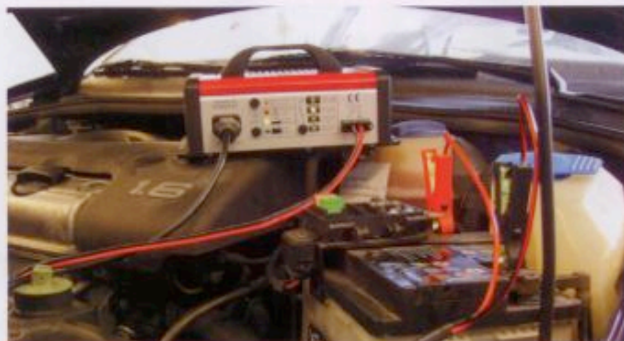
Konditionstraining: Schwache oder tiefentladene Batterien müssen vor dem Prüfen mit dem Belastungstester erst geladen werden. Nur dann ist ein aussagefähiges Prüfergebn möglich.
