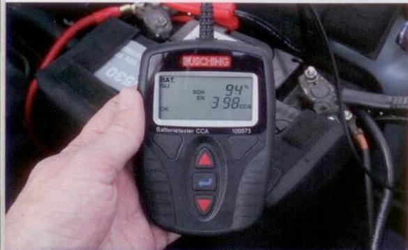
Der Batterietester von Busching soll für alle gängigen Batteriebauarten geeignet sein. Er ermittelt Parameter wie Batteriezustand, Ladezustand, Innenwiderstand und Kaltstartstrom.
