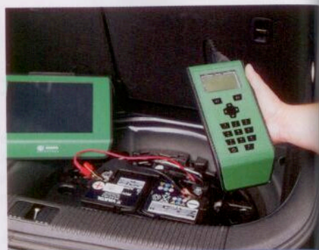
Immer mehr elektrische Verbraucher und immer öfter auch noch ein Start-Stopp-System – eine Batterie muss Höchstleistungen vollbringen. Aufschluss über die Leistungsfähigkeit gibt ein Zustands-Check, etwa mit dem BPC-Tool von Hella Gutmann Solutions. Foto: Hella Gutmann
