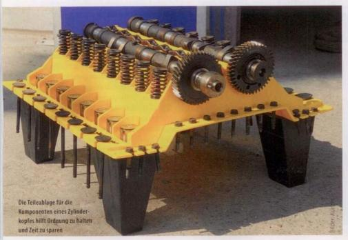
Teile, wenn zum Beispiel die Ventile geschliffen werden, beugt die Teileablage Verwechselungen der Komponenten vor.
