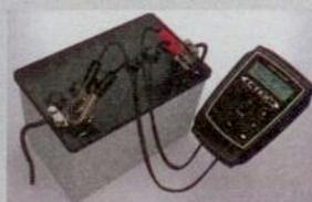
allen 12 V Blei-Säure-Batterien geeignet, die Betriebsspannung reicht von 8-15 V bei einem Prüfbereich von 200-1.200 Ah. [www.ctek.com](http://www.ctek.com)
