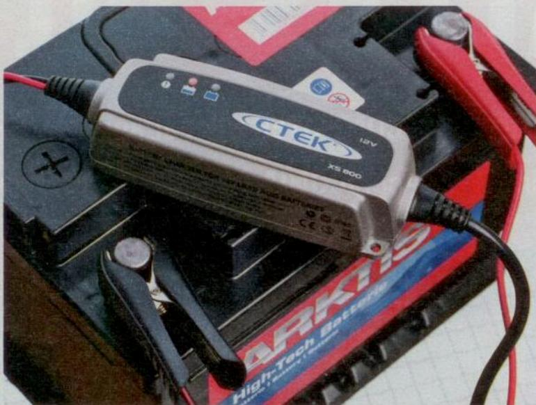
**Aufladen:** Das ist die perfekte Trainingseinheit für schlappe Batterien - einfach mal über Nacht ans Ladegerät hängen. Auch alte Batterien leben so wieder auf
