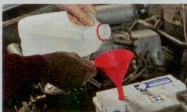
**Auffüllen:** Ist die Batterie nicht wartungsfrei, destilliertes Wasser nehmen
