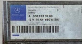
**2 TECHNISCHE DATEN** Die wichtigsten Angaben sind 12 V (Nennspannung), 74 Ah (Nennkapazität) und 680 A (Kälteprüfstrom).
