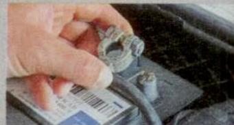
**3 ABKLEMMEN** Muss die Batterie zum Aufladen oder Austausch ausgebaut werden, immer erst den Minuspol (Masse) abnehmen.
