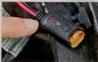
Quick-Connector mit Zustandsanzeige Wird an der Batterie installiert als Schnellkupplung fürs Ladegerät
