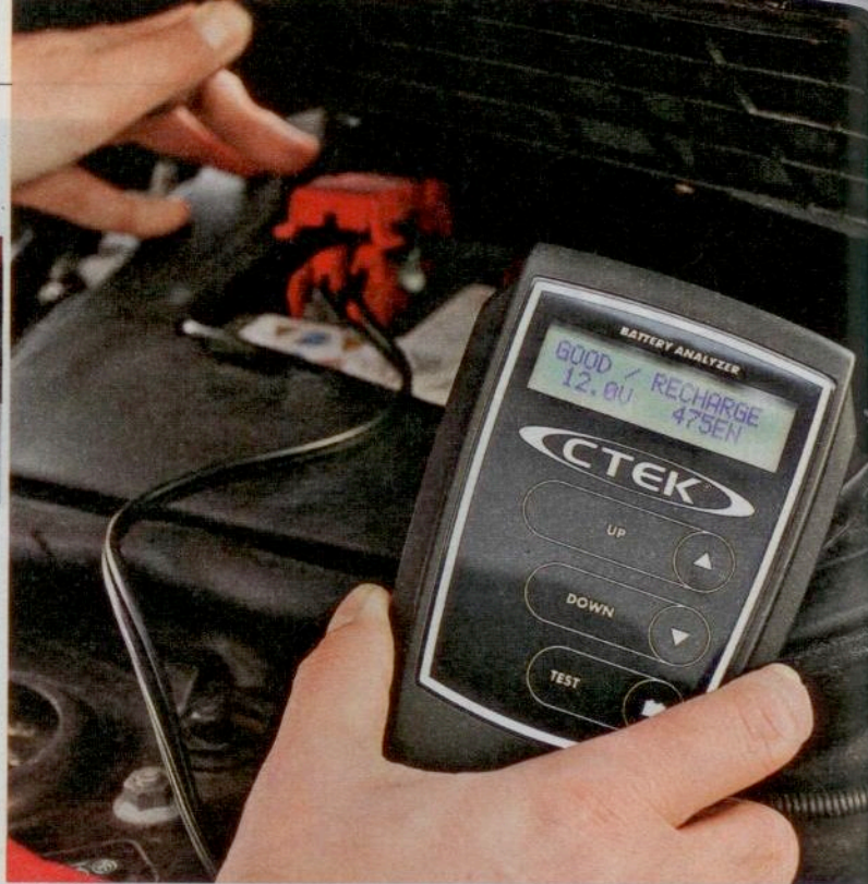
Batterie prüfen Moderne Batterietester messen exakt: Die Batterie des Mini ist okay (good), hat aber nur 12,0 Volt und sollte nachgeladen werden (recharge)
