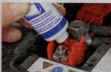
Batteriepole mit Polfett eincremen Verhindert Oxidation an den Klemmen und dadurch Übergangswiderstände
