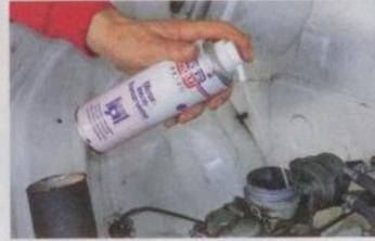
Motorkonservierer schützt Ansaugtrakt und Brennraum vor Korrosion
