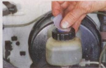
Bremsflüssigkeitsbehälter: Öffnung abkleben, das hält Wasser draußen
