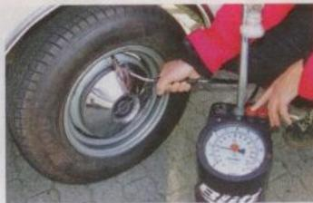
Reifendruck erhöhen, um die Gefahr von Standplatten zu verringern
