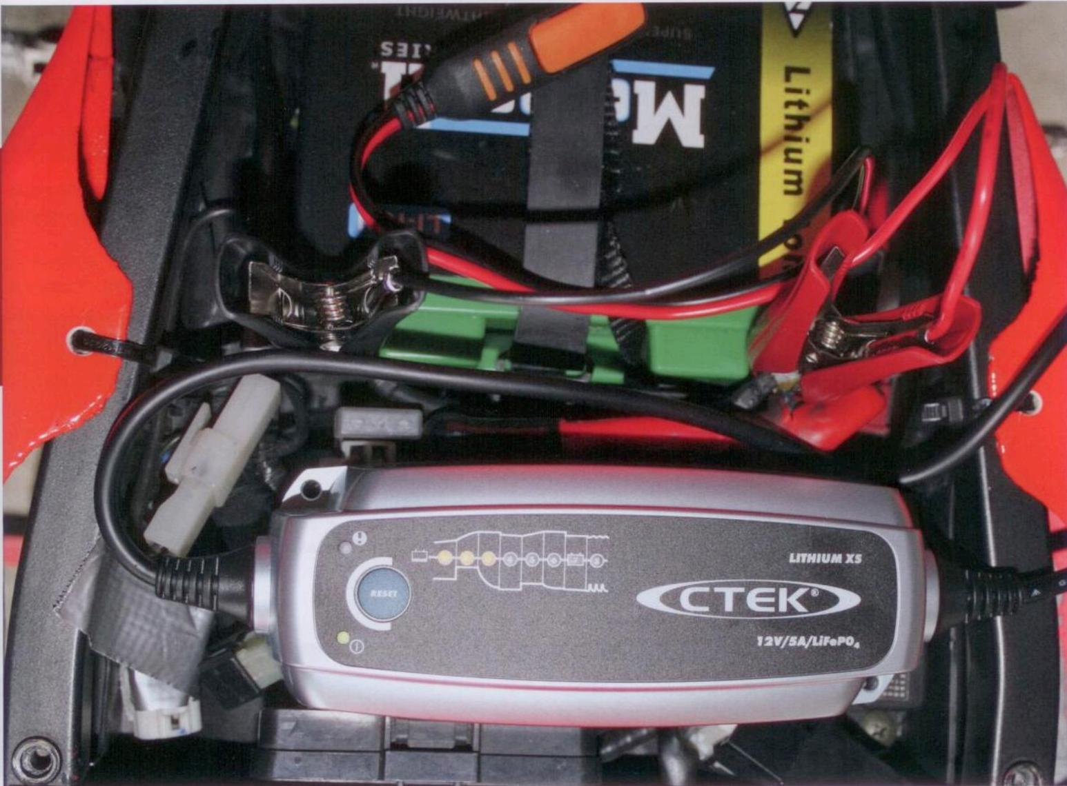
Das Ladegerät ist mit einer 8-stufigen Ladekennlinie ausgestattet, die mittels einer additionalen LED-Anzeige sichtbar gemacht wird. Bei unserer Motocell Batterie, die in dieser Saison noch kein Ladegerät gesehen hatte, leuchteten nach dem Anklemmen drei der acht Kontrollleuchten auf. Das heißt, laut Gerät war unsere Batterie zwar noch einsatzfähig, aber eben nicht voll aufgeladen.
