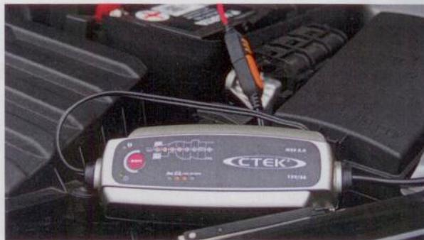
ze bei 110 Ah. Als Besonderheit verfügt das Ctek über ein Rekonditionierungsprogramm, das einem schwachen Akku in der GF-Redaktion bereits neuen Schwung einhauchen konnte. Auch die u.a. bei BMT-Autos verbauten AGM-Batterien stellen kein Problem dar. Rund 90 Euro kostet das Ladegerät mit Tasche, Anschlussklemmen sowie einem koppelbaren Anschluss mit Ringösen zum dauerhaften Verbleib im Auto. Praktisch. Das Ctek MXS 5.0 ist ein rundum empfehlenswerter, praktischer Allrounder.
