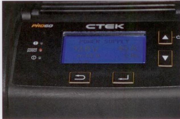
Stützladung mit dem Pro 60. Die Aufnahme zeigt, dass 35 A vom Ladegerät zur Batterie fließen.
