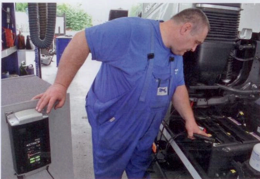
Gut geladen: Das Herzstück im Bordnetz moderner Nutzfahrzeuge sind die Starterbatterien. Um sie optimal zu laden, ist ein elektronisches Ladegerät wie das „MXTS 70“ von Ctek von Vorteil. Es lässt sich auf den jeweiligen Batterietyp einstellen, lädt temperaturkompensiert und hält automatisch die maximale Ladeschlussspannung ein. Bild: Kuss
