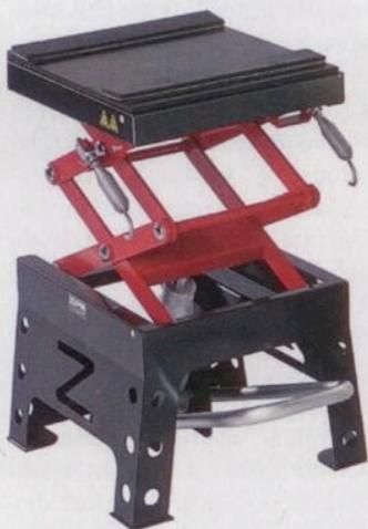
Hebt zwar nur 135 Kilogramm, die aber dafür umso lässiger: Mit gewitzt angebrachten Federhaken hält Zupins „Z-Lifter“ aufgebockte Enduros, Sumos oder Wettbewerbs-Crosser automatisch an den Fußrasten fest. Sicherer Stand garantiert dabei unter anderem das Eigengewicht des Z-Lifters: Der per Fußbedienung auf bis zu 90 Zentimeter Arbeitshöhe hochfahrende Bock bringt inklusive Hebehydraulik 29 Kilo auf die Waage. Impassant ist auch der Preis: Der High-techheber wuchet 598 Euro vom Konto.
