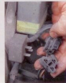
Kontrolle während der Fahrt: Steigt die Spannung zu hoch, kann der Entstörer am Regler (links) Schuld sein
