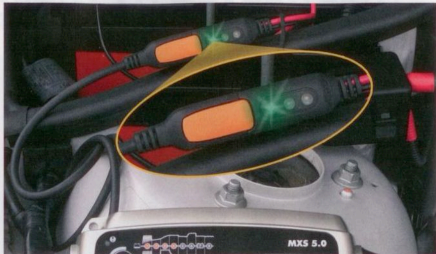
Die Ladeampel zeigt den Ladezustand der Batterie an. Das MSX 5.0 lässt sich direkt an die Ampel anschließen.
