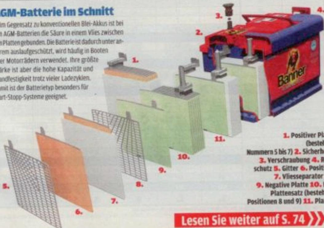
1. Positiver Plattensatz (besteht aus den Nummern 5 bis 7)
