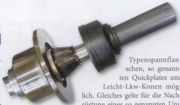
Typenspannflanschen, so genannten Quickplates und Leicht-Lkw-Konen möglich. Gleiches gelte für die Nachrüstung eines so genannten Uni-Lug-Adapters und für die Aufnahme von Motorrad-Rädern. Die Spannkraft sei stets konstant, die Spanggeschwindigkeit einstellbar.
