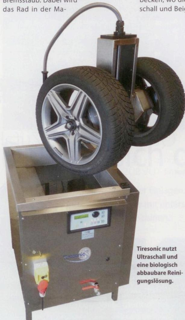
Tiresonic nutzt Ultraschall und eine biologisch abbaubare Reinigungslösung.
