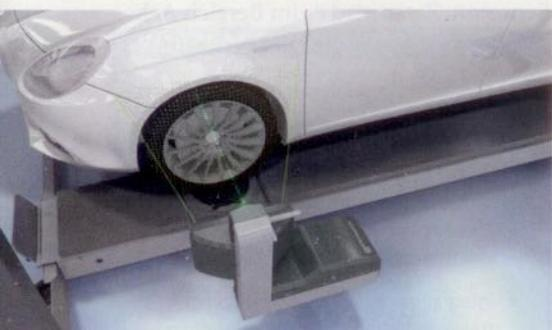
Beissbarth Touchless: Kameras erfassen die Lichtpunkte zur Berechnung eines 3D-Modells.
