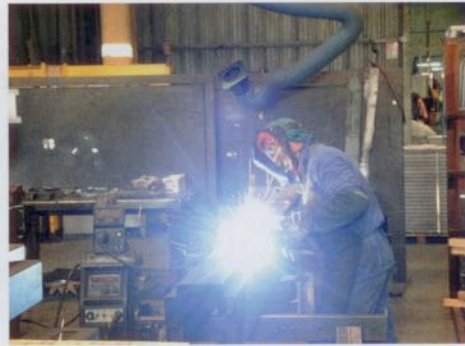
Im Produktionswerk Sirio werden zahlreiche Bauteile und Komponenten hergestellt und teilweise auch per Hand geschweißt.
