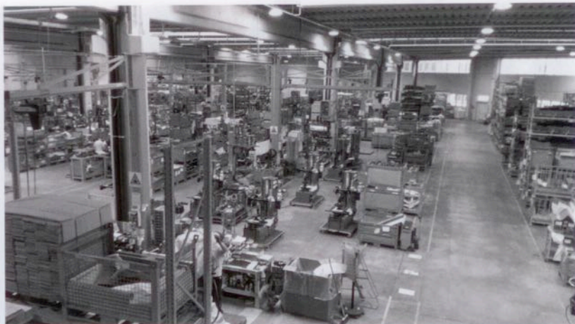
Die Butler-Produktion ist modular aufgebaut: Aus den von den Schwesterfirmen angelieferten Bauteilen entstehen auf sogenannten Produktionsinseln zunächst Komponenten, die dann wiederum zu kompletten Montier- oder Wuchtmaschinen zusammgebaut werden
