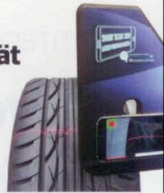
Das Smart Scan 300 ist ein tragbares, laserbasiertes Profilometer von GL Messtechnik.
