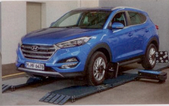
Die neue LTB 300 von Beissbarth: Fahrwerkvermessung, Scheinwerferprüfung und FAS-Justage auf einen Streich.
