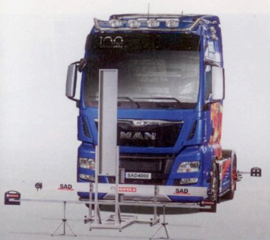
FAS Justage bei Lkw mit den Prüfsystemen SAD 5000 und SAD 4000 von Haweka
