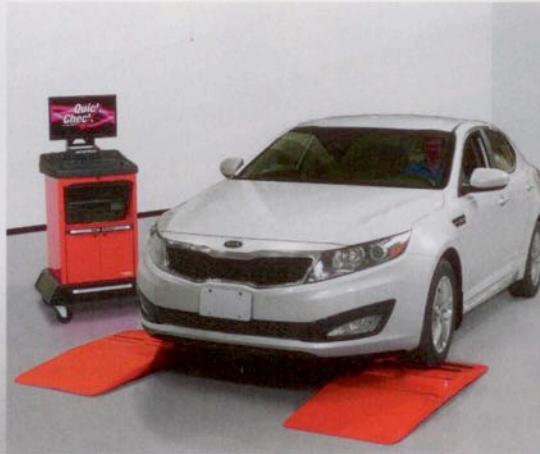
Der Hunter Quick Check mit integrierter Profiltiefenmessung
