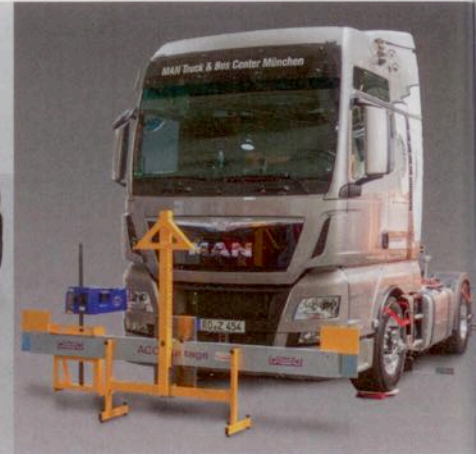
Mit HD-30 Easy Touch von Koch inklusive LC-40 ACC lassen sich ACC-Sensoren einstellen.
