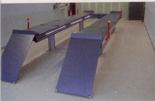
Verfügt über zwei separate Hubeinheiten: die Quattrlift von Autopstenhoj.
