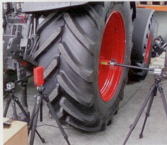
Vor der eigentlichen Messung sind einige Vorbereitungen zu treffen. So zum Beispiel das richtige Positionieren der drei Messsensoren.
