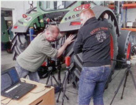
Karl-Heinz Harms (li.) und Nils Westphalen drehen den Reifen, die Sensoren erfassen dabei den Höhengschlag von Felge und Stollen.
