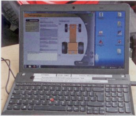
Die Software führt den Anwender durch die einzelnen Schritte. Wichtige Angaben sind der Reifendurchmesser und die Anzahl der Stollen.
