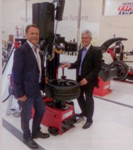
Werner Haidacher (r.), Geschäftsführer AWA Handel, präsentiert das Universal-Reifenmontiergerät Promax Force 1120, mit dem man herkömmliche Stahlfelgen genauso montieren kann wie Runflat-Räder bis 30 Zoll. Alles mit einer Maschine, lautet die Devise
