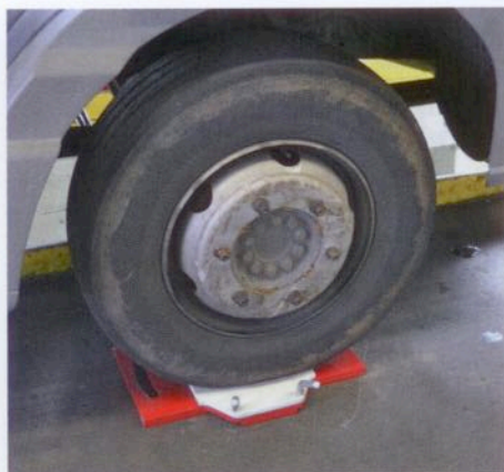
Die Vorderräder stehen auf Drehplatten.
