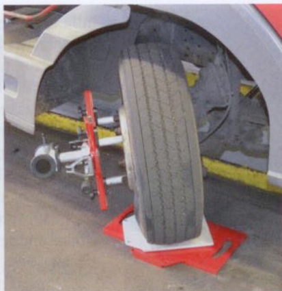
Durch das Drehen des Lenkrads nach links und rechts misst man den gesamten Lenkeinschlagswinkel.
