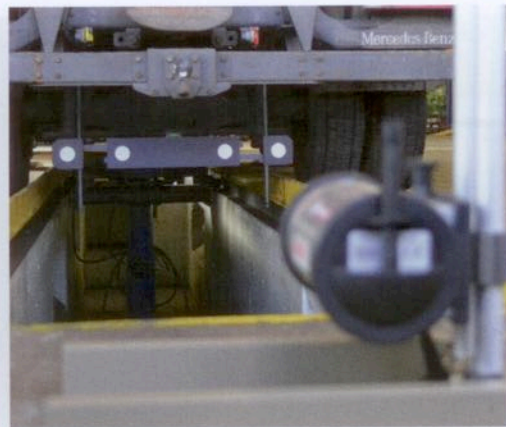
Mit dem Messsystem CMC 4000 kann man die Geometrie eines Nfz-Rahmens vermessen.
