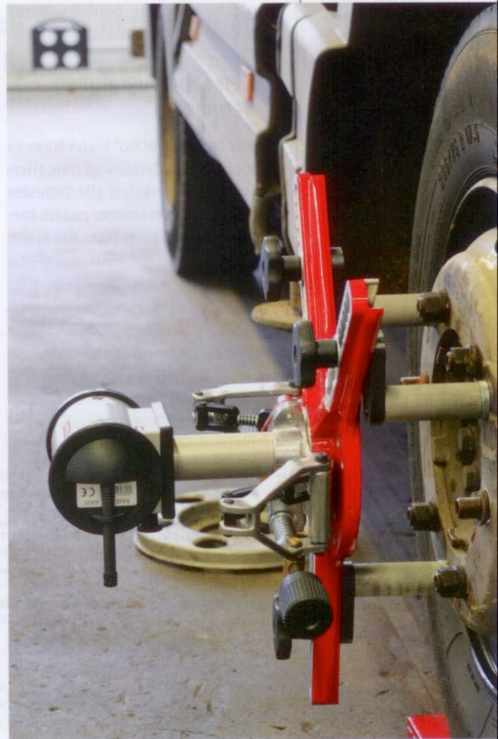
Die Targets um das Fahrzeug dienen als Messpunkte für die Kameras.
