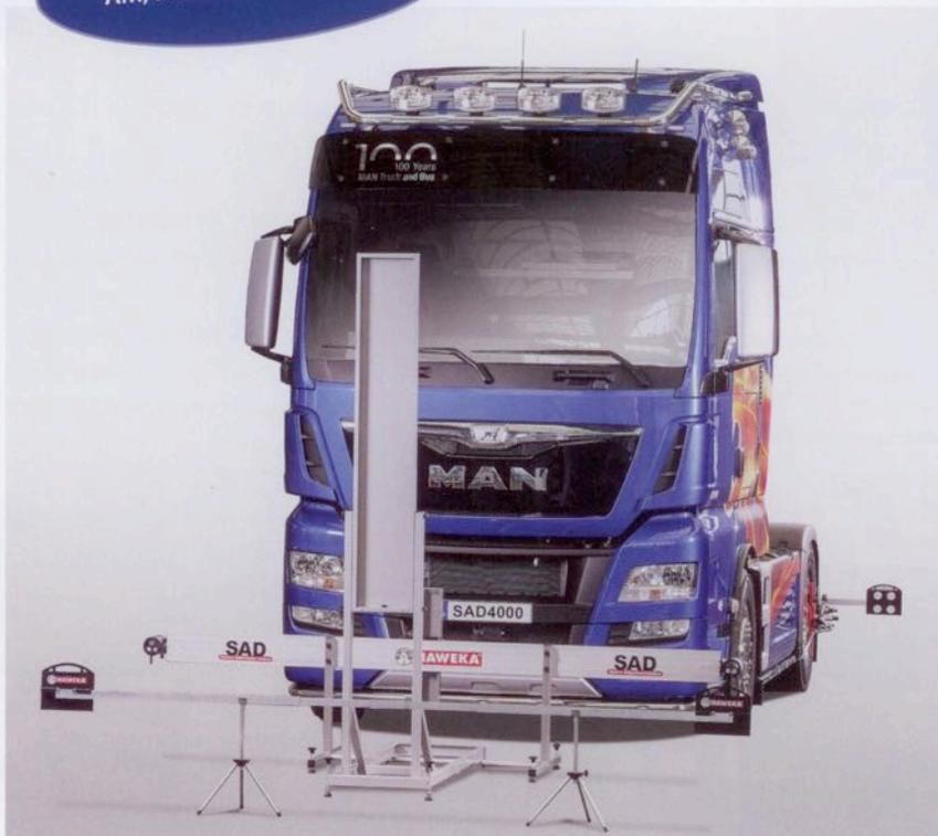
Einfach aufrüsten: Mit den zusätzlichen Prüf- und Einstellmodulen „SAD500“ und „SAD4000“ lassen sich die Achsmessanlagen der „Axis“-Baureihe von Haweka zum Prüfen und Justieren von Radar- und Kamera-Sensoren erweitern. Im Bild das „SAD4000“ für das mobile Kamera-vermesssystem „Axis4000“. Bild: Haweka
