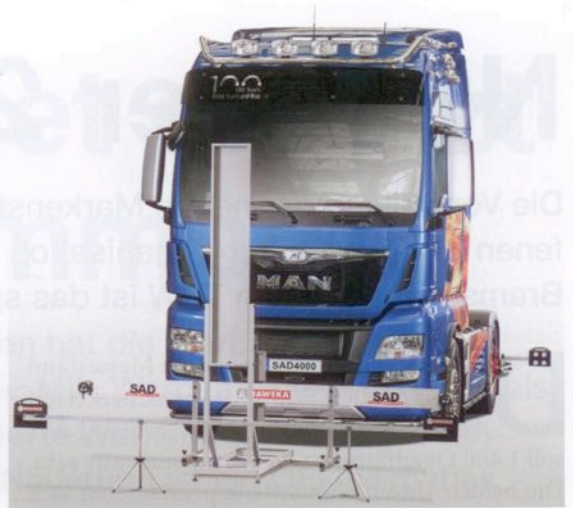
Zum Einstellen von Sensoren und Kameras von Fahrerassistenzsystemen hat Haweka neue Funktionen in seine Achsvermessung eingebaut.
