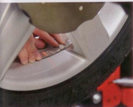
Das präzise Anbringen der Auswuchtgewichte ist ein entscheidender Faktor für das reproduzierbare Auswuchten. Ein Laserstrahl ist für das Positionieren sehr hilfreich.
