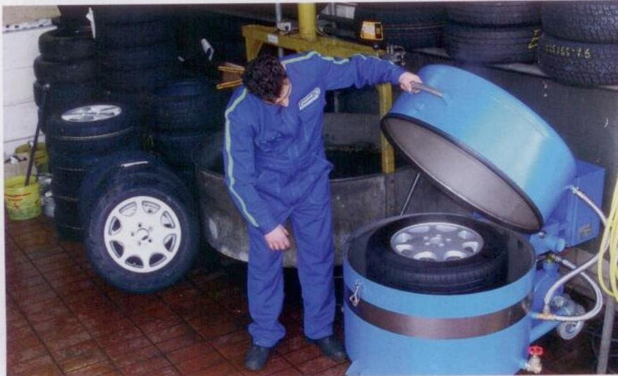
Die Rosink-Radwaschmaschine RRW ist eine vollautomatische, geschlossene Anlage, die mit Wasserdruck arbeitet. Sie kann auch für die Teilereinigung verwendet werden.
