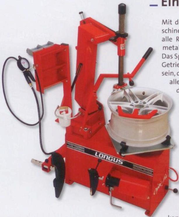
Die Longus-DQN-Montiermaschinen sollen die Zeiten für die Demontage- und Montagearbeiten verkürzen und materialschonend arbeiten.
