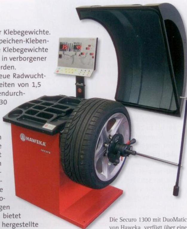
Die Securo 1300 mit DuoMatic von Haweka verfügt über eine Schnellspannvorrichtung, die es erlaubt, das Rad ohne zusätzliche Kone schneller aufzuspannen und exakt zu zentrieren. Foto: Haweka
