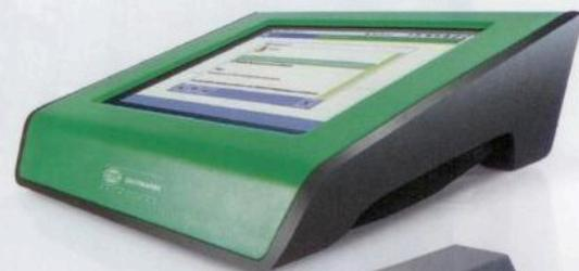
Dank Funkschnittstelle kann der Anwender ohne Kabelverbindung zum Auto arbeiten.
