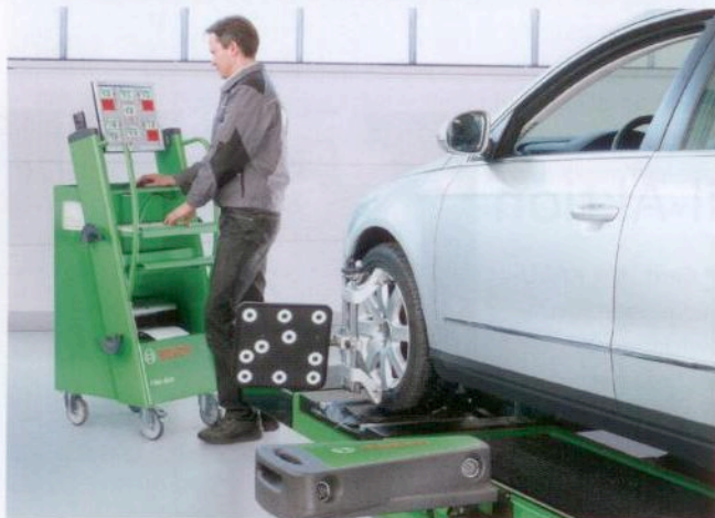
Mit dem neuen FWA 4630 benötigt der Werkstatt-Mechaniker für eine präzise Achsvermessung an einem Pkw nur rund sieben Minuten.
