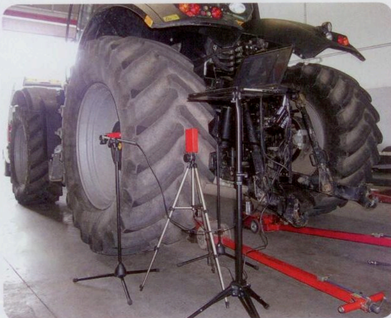
Das RPV 1300-System von Haweka erfasst mit Lasertechnik die Ist-Werte für den Rundlauf an der Felge und dem Reifen.
