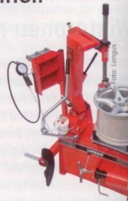
Mit der Montiermaschine Longus Opti-fit lassen sich alle UHP- und Runflat-Reifen montieren.
