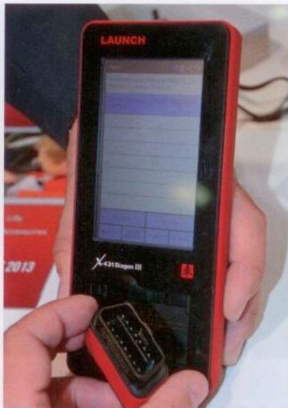
Launch: kabelloser OBD-Adapter X-431 Diagon III. Bild: Mareis
