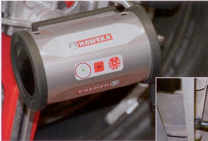
Im grünen Bereich: Eine grün leuchtende LED am Kamerakopf (Kreis) signalisiert dem Anwender, dass das System richtig eingestellt und messbereit ist.
