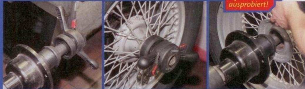
Reifendienste können Speichenräder häufig nicht korrekt auswuchten. Ihre Standardvorrichtungen spannen die Nabe zwischen zwei Planflächen, was zu falschen Messwerten führt. Abhilfe schafft der spezielle Zentriersatz von *Haweka*, der auf alle Wuchtmaschinen passt und das Rad exakt wie am Fahrzeug positioniert. Er besteht aus zwei Distanzstü-
