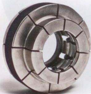
Die Vorteile dieser Lösung liegen in der äußerst genau gefertigten Bolzenführung. Sie garantiert eine planliegende Typenplatte, welche mit den Bolzen in alle Radmutterlöcher und somit fest gegen den Flansch der Wuchtmaschine drückt. Dabei ist es egal, in welcher Stellung das Rad auf die Maschine sitzt, es erfolgt immer die exakte Auswuchtmessung an ein und derselben Position.
