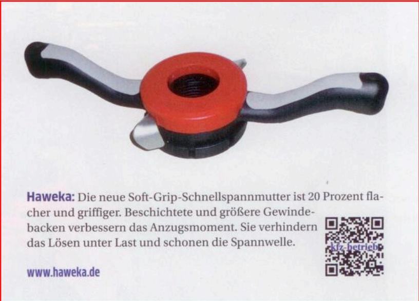
**Haweka:** Die neue Soft-Grip-Schnellspannmutter ist 20 Prozent flacher und griffiger. Beschichtete und größere Gewindebacken verbessern das Anzugsmoment. Sie verhindern das Lösen unter Last und schonen die Spannwellen.
