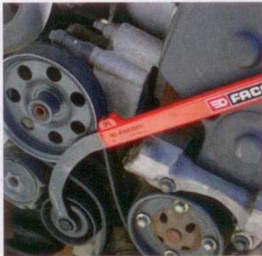
Für den Ein- und Ausbau von elastischen Riemen bietet Facom ein Spezialwerkzeug an. Das Set besteht aus zwei Teilen: Das erste Werkzeug hilft beim Aufspannen des Riemens auf die Riemenscheibe, und das zweite erleichtert das Abnehmen des Riemens. Zum Anbringen eines Riemens wird das Facom-Werkzeug zwischen den Riemen und die Riemenscheibe gesetzt und die Kurbelwelle mit der Knarre in
