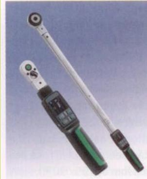
Beim neuen Drehmoment-/Drehwinkelschlüssel Manoskop 714 von Stahlwille kann das Anzugsverfahren je Schraubfall aus einer Kombination von Drehmoment- und/oder Drehwinkelmessung gewählt werden. Je Betriebsmodus stehen dem Anwender dazu vier Messmodi (Drehmoment, Drehwinkel, Drehmoment-Drehwinkel, Drehwinkel-Drehmoment) zur Verfügung. Die Konfiguration des Werkzeugs erfolgt über die Software Sensomaster. Bis zu 200 Schraubfälle in maximal 25
