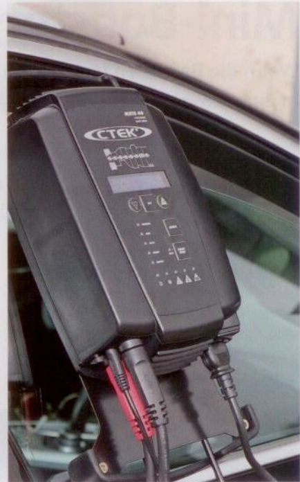
Das Ladegerät sollte beim Service in der Werkstatt angeschlossen werden, um Diagnosearbeiten störungsfrei durchführen zu können.
