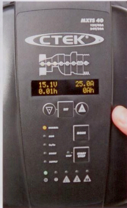
Der Ladezustand wird über die Comfort-Indicator-Ladezustandsanzeige festgestellt und dem Anwender angezeigt.
