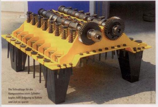
Teile, wenn zum Beispiel die Ventile geschliffen werden, beugt die Teileablage Verwechselungen der Komponenten vor.
