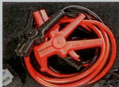
**ÜBERBRÜCKUNGSKABEL** Für den Pannentatter gilt: Das Kabel mit dem größeren Durchmesser ist immer die bessere Wahl, so steht mehr Strom zum Starten bereit.
