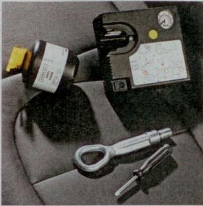
Nur wenige Helfer ab Werk: Dichtmittel, Kompressor, Abschleppöse und Schraubendreher
