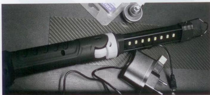
Eine durchschnittliche Leuchtdauer von gut 2,5 Stunden, eine kompakte Länge von rund 330 mm sowie ein extrem geringes Gewicht von gerade einmal 280 g machen diese praktische Leuchte in jeder Werkstatt zu einem wichtigen Helfer. Das Aufladen erfolgt mittels des im Lieferumfang enthaltenen Netzteils das lediglich mit der Micro-USB-Ladebuchse verbunden wird.
