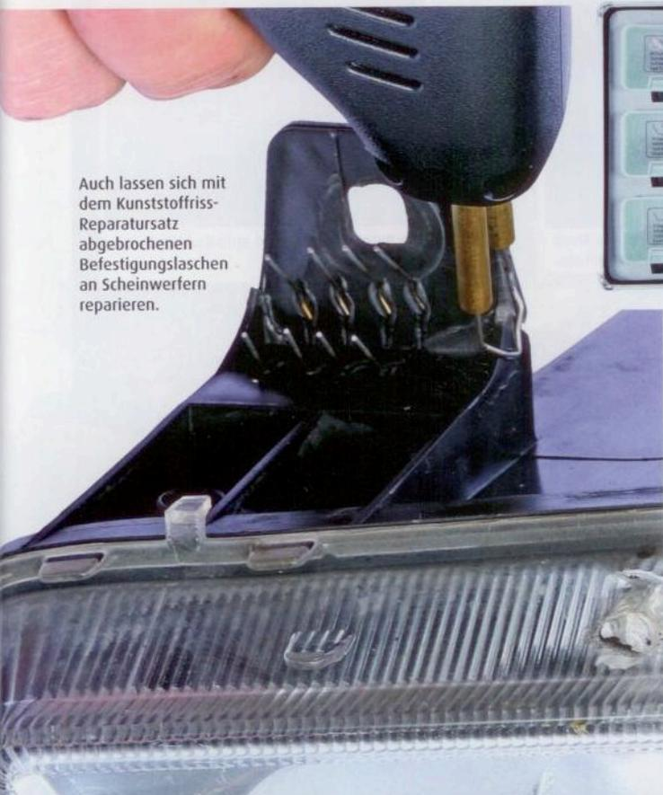
Auch lassen sich mit dem Kunststoffriss-Reparaturset abgebrochenen Befestigungsglaschen an Scheinwerfern reparieren.
